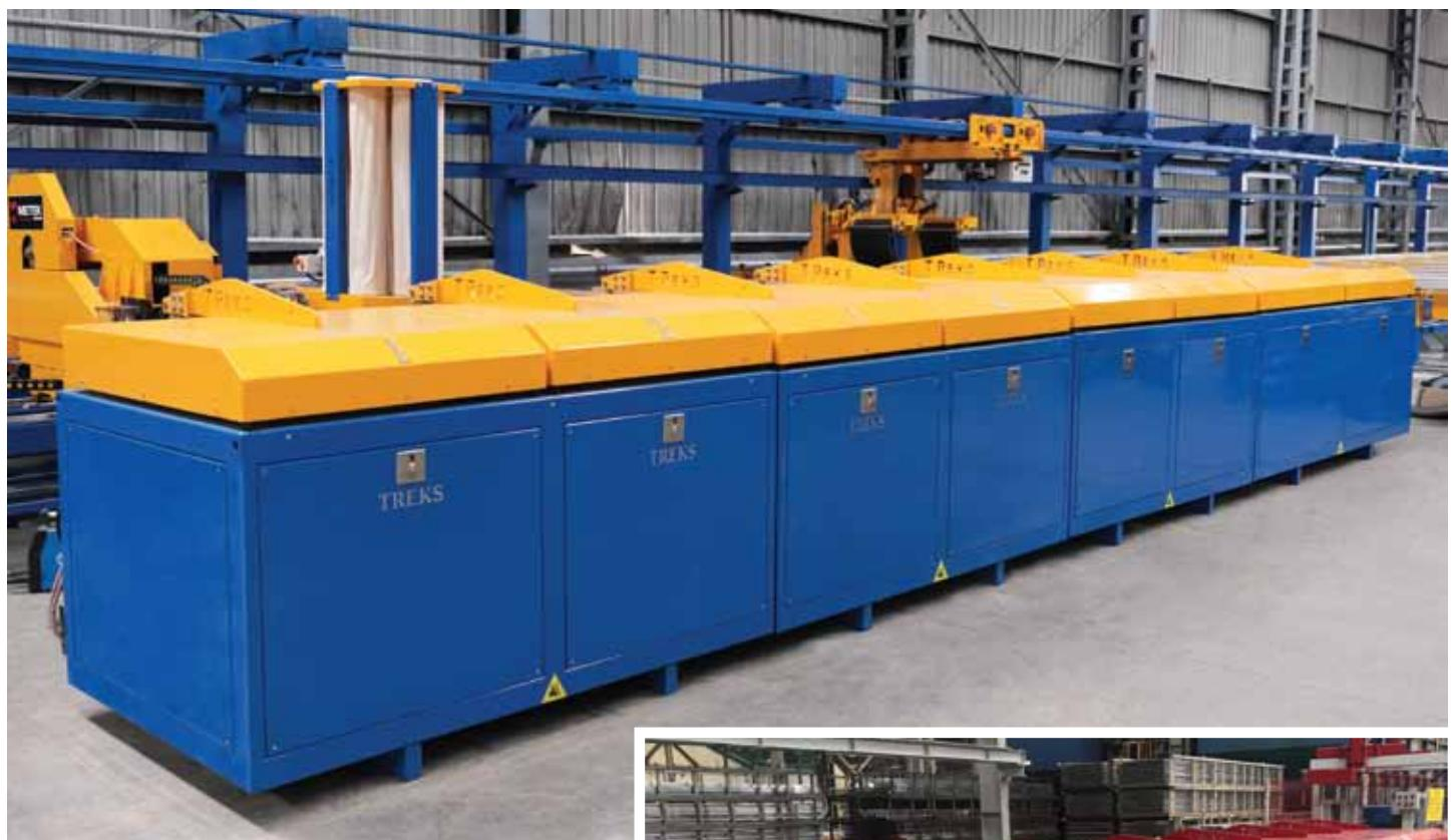
Akıllı kalıp ocağı sahip olduğu özel yazılım ile kalıbin hızlı ve aşırı ısınmasını engelleyerek kalıp ömrünün uzamasını sağlar.
