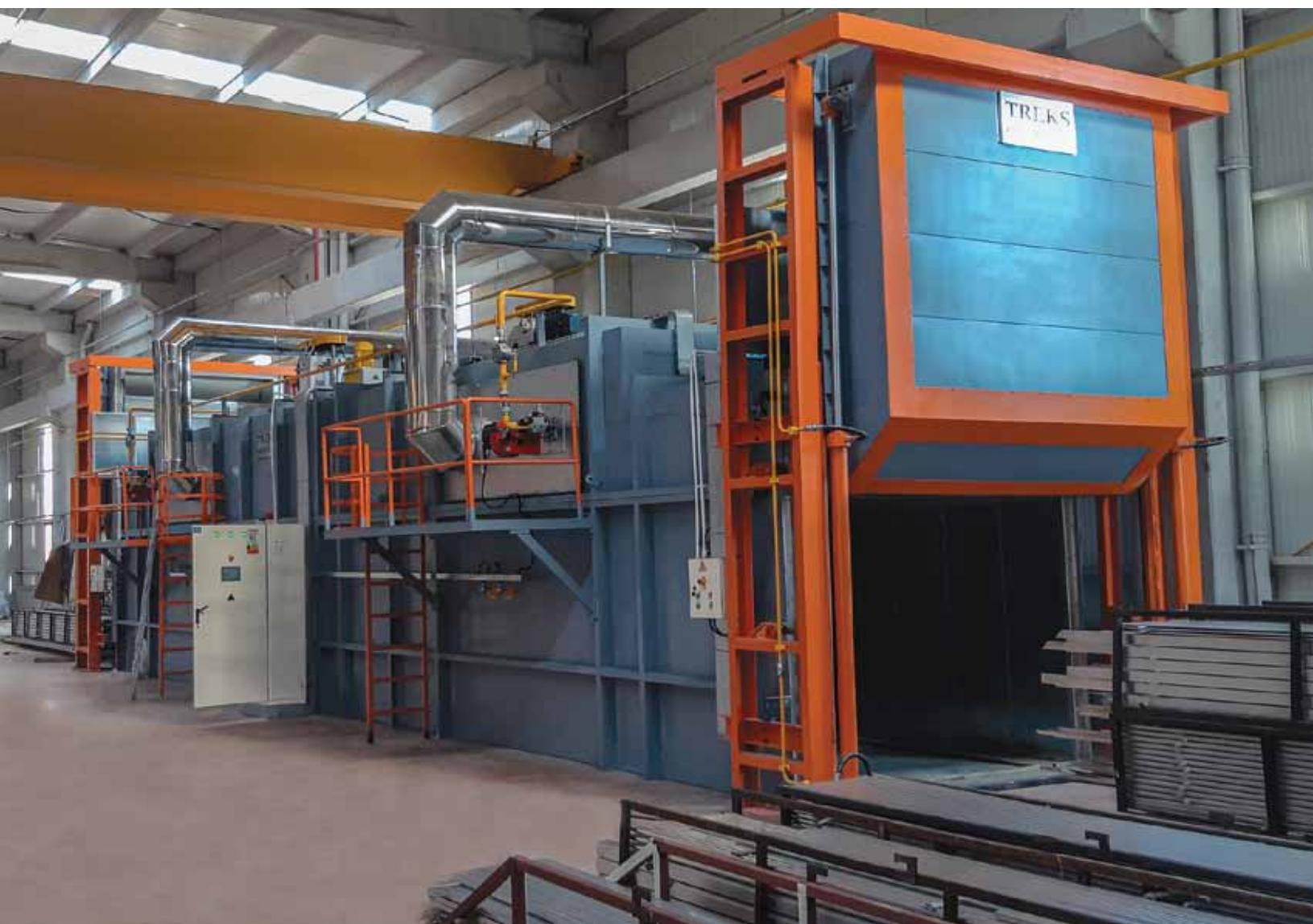
Termik fırın olarak bilinen bu fırınlar, ekstrüzyon yöntemiyle imal edilmiş alüminyum profillere sertlik kazandırmak için kullanılır.
