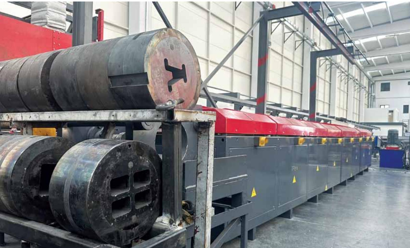
Akıllı kalıp ocağı geleneksel ocaklara kıyasla kalıpları 2 kat daha kısa zamanda ısıtır. Bu sebeple aynı anda ısınmakta olan kalıp sayısı normalin yarısı olur ve dolayısıyla fırın yapısından kaynaklanan ısıl kayıplar oldukça azalır.
