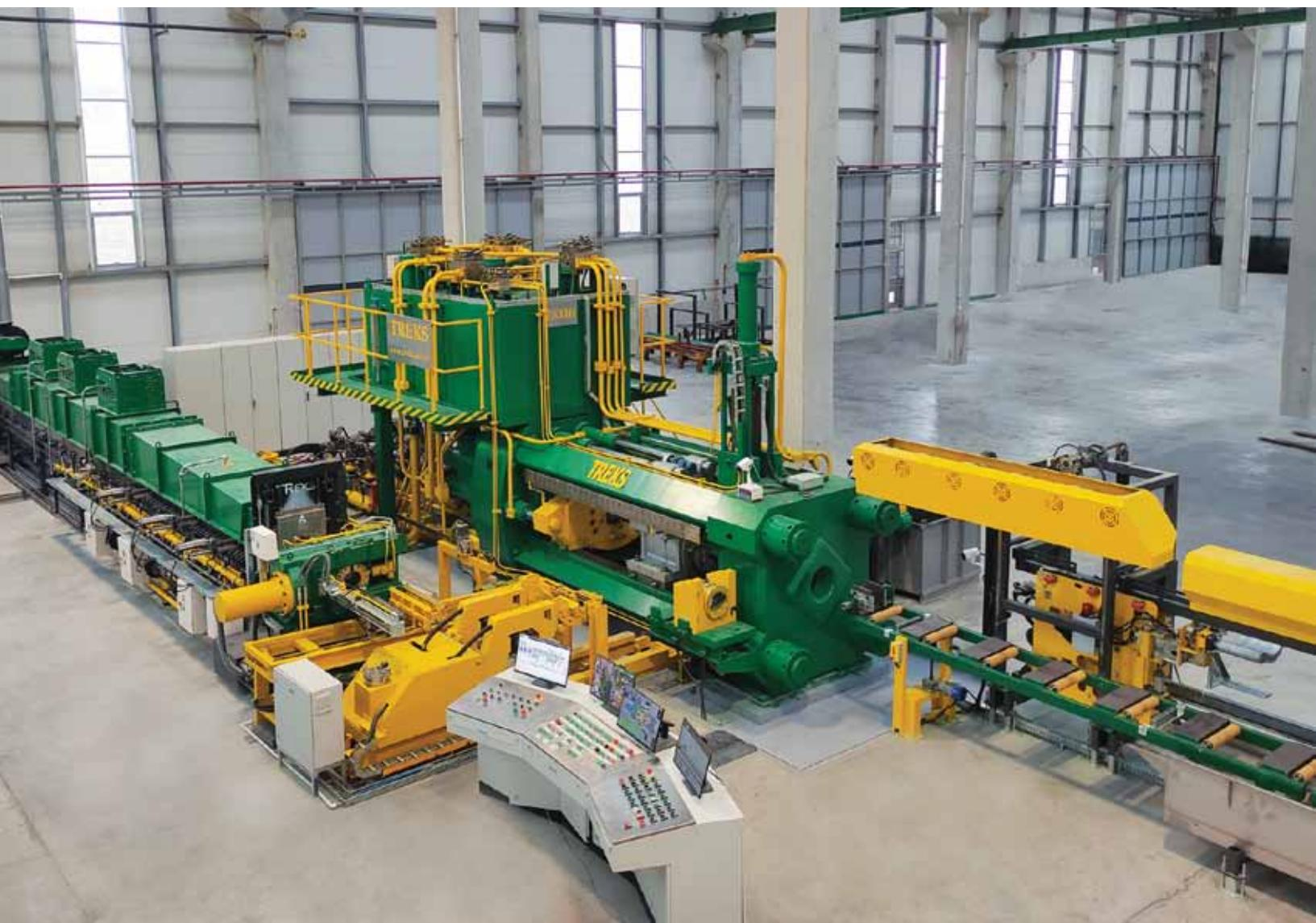
Treks Mühendislik, profil üretimi konusundaki tecrübelerinin kılavuzluğunda, 400 MT dan 10.000 MT a kadar güçlerdeki direkt, indirekt ve double action alüminyum ve bakır preslerini optimum kalite ve maliyetler dahilinde ekstrüzyon sektörünün hizmetine sunmaktadır.
