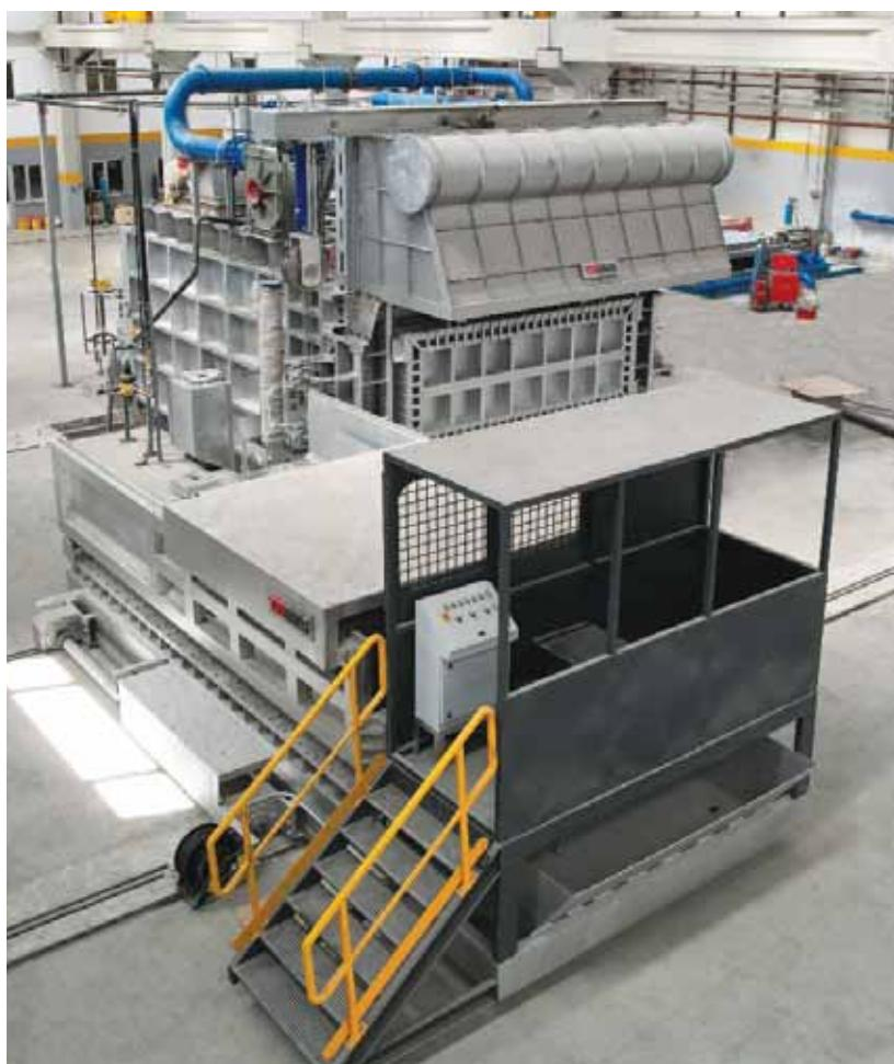
Alüminyum döküm tesislerinde kullanılan, sıvı metal hamaddeyi sağlayan fırınlardır. Hurda tipine, kapasiteye ve yakıt tipine uygun olarak düşük enerji sarfiyatı ve minimum metal kaybı ilkelerine göre tasarlanıp imal edilir.
