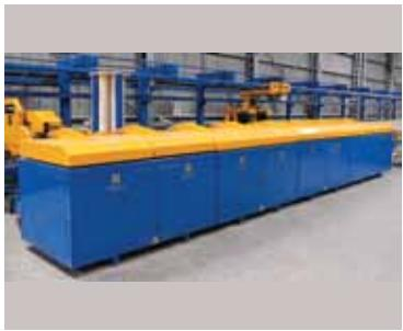
Kalıp Isıtma Fırınları / Die Heating Furnaces
