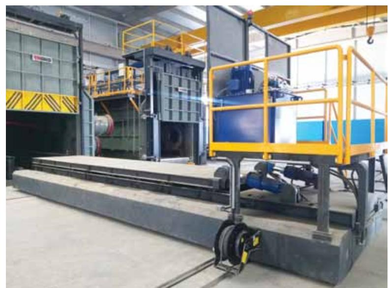
Müşterilerimizin talepleri doğrultusunda, 10 Ton ile 40 Ton kapasite aralığında, manuel ve otomatik prensiplerde çalışabilen, Alüminyum Biyet Homojenizasyon Hattı üretimi, montajı, devreye alma ve teknik servis hizmetlerini vermekteyiz.
