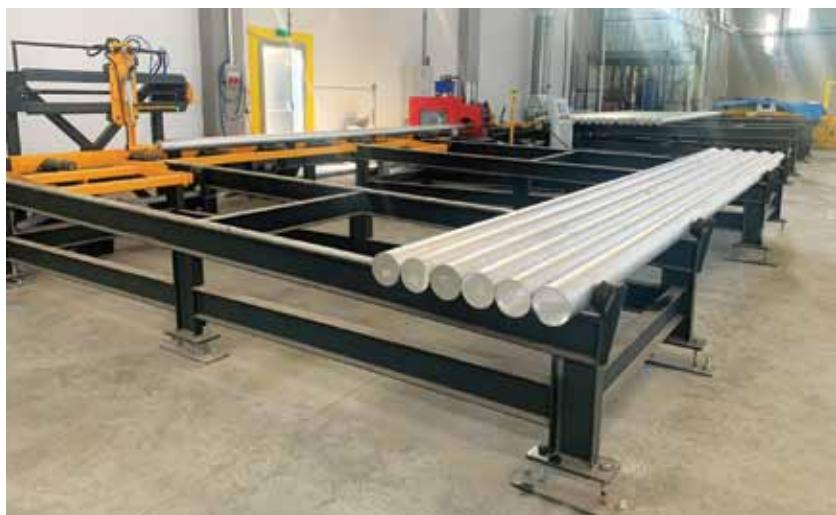
Alüminyum Biyet Üretim Tesislerinde kullanılan, 4" ile 14" biyet çapı aralığında, otomatik veya manuel olarak çalışabilen Biyet Kesim Testereleri üretimi, montajı, devreye alma ve teknik servis hizmetlerini vermektediriz.
