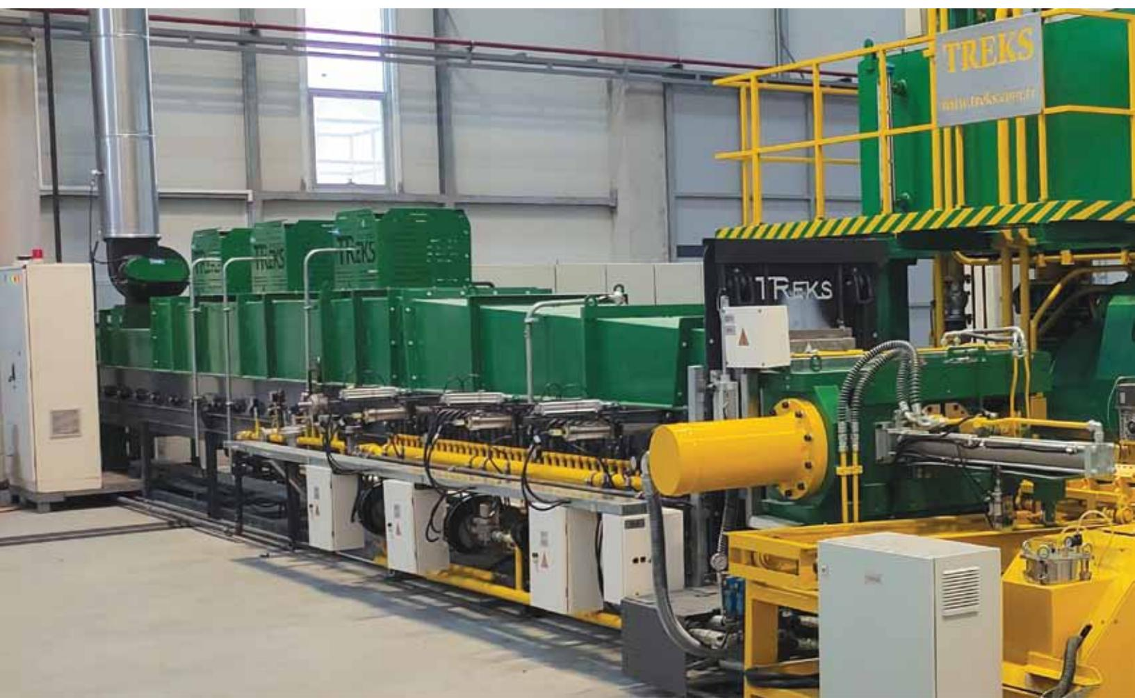
Pres üretim hızına adapte edilerek dizayn edilebilen biyet ısıtma fırınlarımız, Treks Mühendislik tarafından geliştirilen yatak dizaynı, 18 m<sup>3</sup> / tonun altında garanti ettiğimiz gaz sarfiyatı ve üstün işçilik kalitesi ile hizmetinizdedir.
